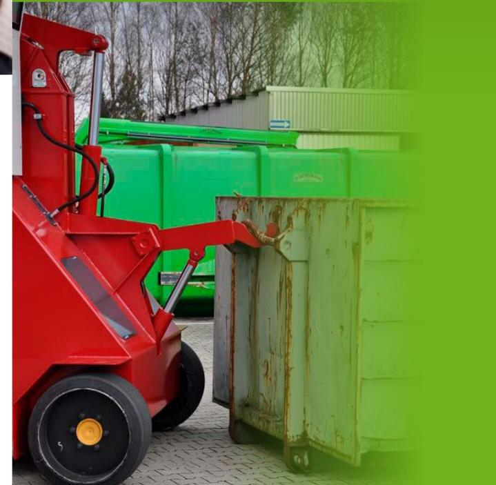
**Der BERGMANN Roll-Packer RPM 7700 Jumbo für den mobilen Einsatz an beliebigen Plätzen eines Standortes.** Der Mobil Jumbo ist stark, wendig und verfügt zusätzlich über eine Containerverfahrenseinrichtung.
