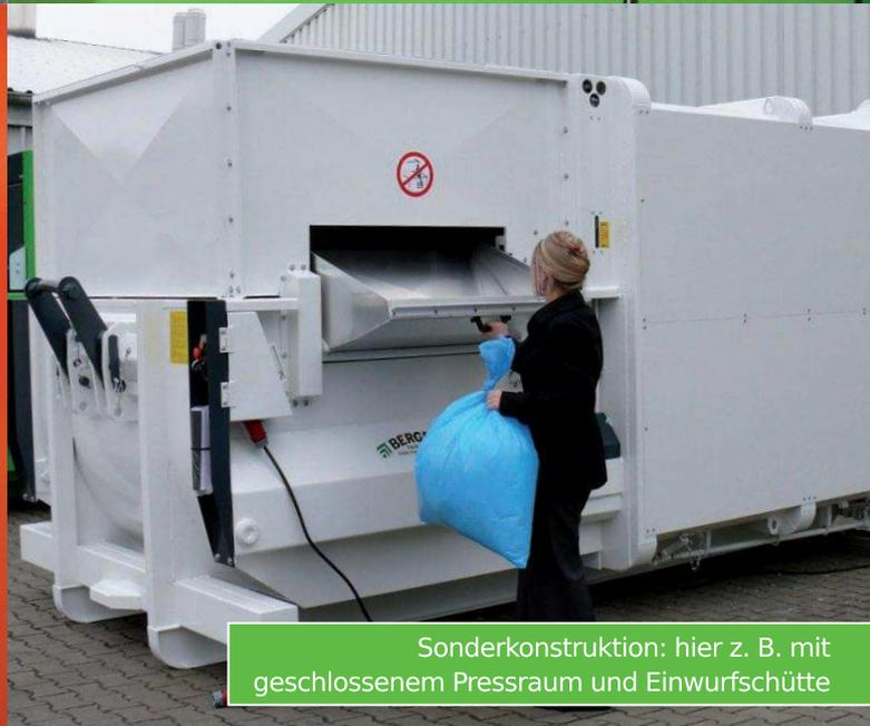
Sonderkonstruktion: hier z. B. mit geschlossenem Pressraum und Einwurfschütte
