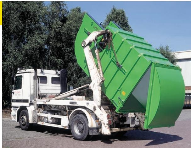
Die seitliche Konizität der Behälter löst eine problemlose Entleerung zu. Die Aufnahmezapfen der Absetzkipper-Ausrüstung können für die verschiedenen Fahrzeugaufbaufabrikate verstellt werden.
